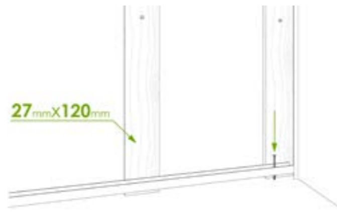
Abb. 4d Detail: Vorschlag Abschlussvariante zum Boden – Bodenprofil
